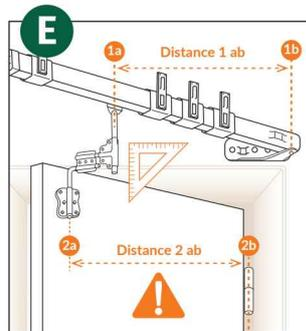
**E** Ensuite, bloquez sur la barre la vis du curseur fixe. Immobilisez de manière à ce que la distance de l'axe des gonds de porte à l'axe du support-boîtier (2ab) soit **égale** à celle de l'axe du support charnière à l'axe de la vis du curseur fixe (1ab). Ainsi l'appareil en se développant dessinera dans toutes les positions un parallélogramme parfait.
