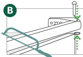
**B** Une fois la charnière posée, mettre en place la barre au moyen de l'axe sur le support charnière. Si besoin, couper cette barre à votre mesure (largeur de la porte) à l'aide d'une simple scie à métaux.
