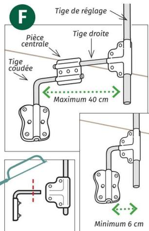
**F** Réglage en profondeur de 6 à 40 cm Assurez-vous que la tige de réglage rivée sur curseur fixe est bien perpendiculaire à la barre/bras. On obtient le réglage en profondeur par l'équerre réglable et en coupant, si besoin, l'excédent de tige.
